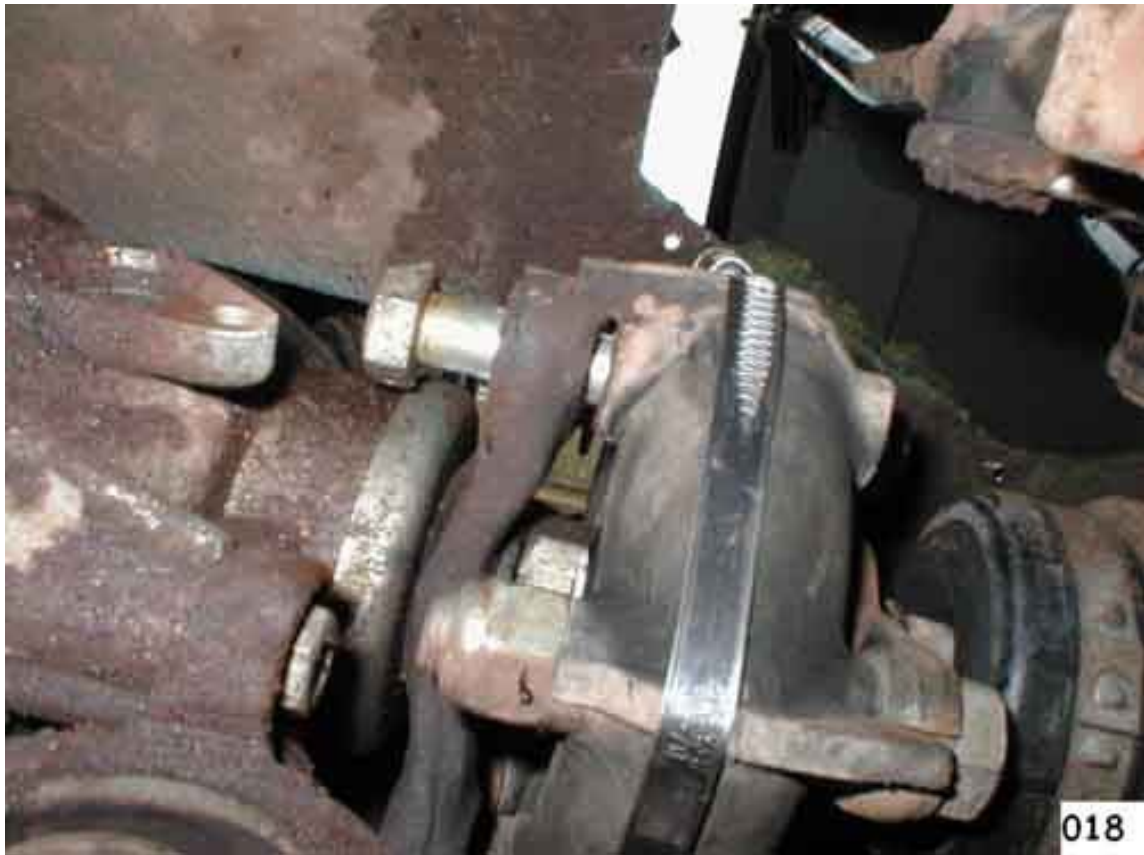
(Fig. 19). Allentare i 4 dadi dei supporti del riduttore.
