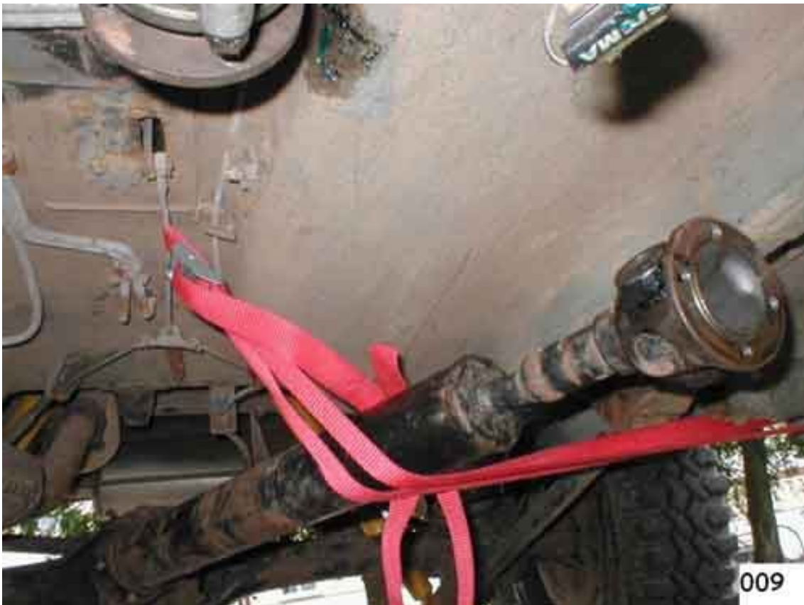
(Fig. 10). Staccare i collegamenti sul riduttore.
