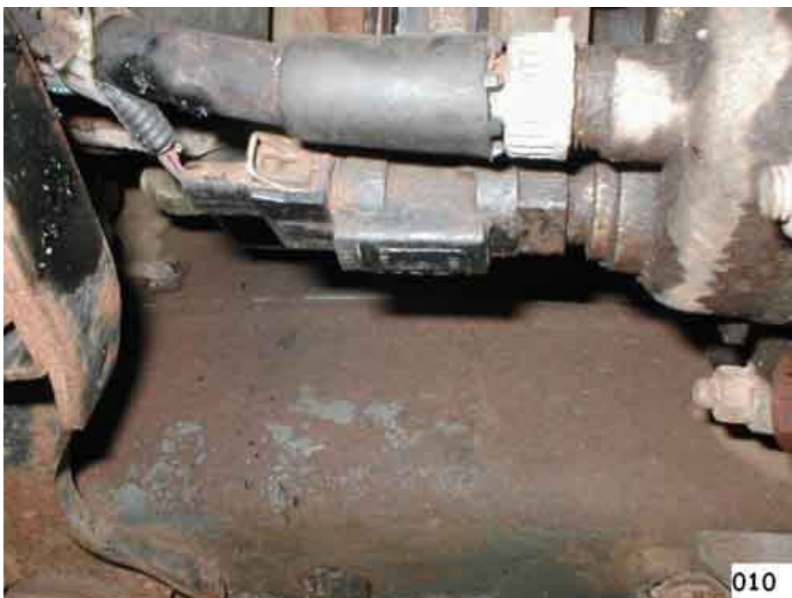
(Fig. 11). Staccare i collegamenti sul cambio.
