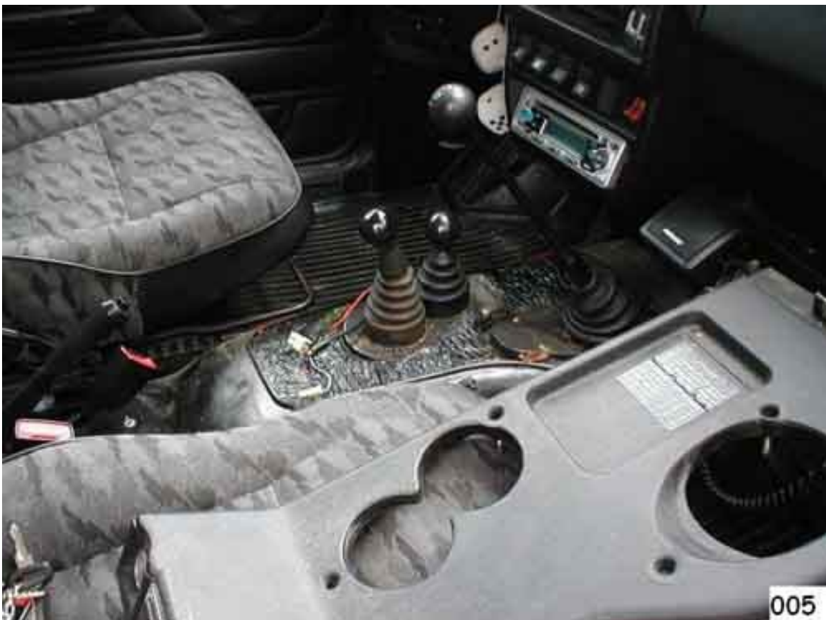
(Fig. 5). Togliere il rivestimento plastico dal tunnel centrale, staccare l'accendisigari.
