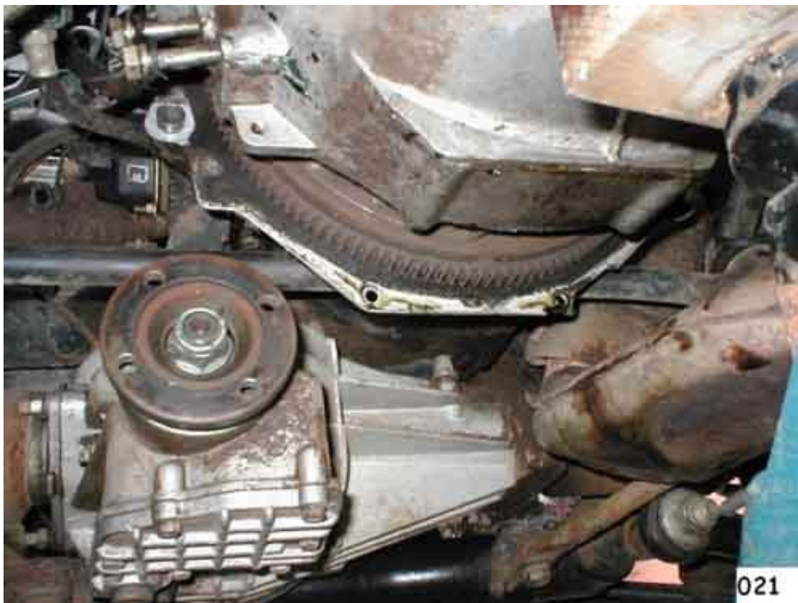
(Fig. 22). Sfilare il cambio facendo scendere lentamente il cric; se è presente dell'olio all'interno della campana (come da foto) sostituire il paraolio.
