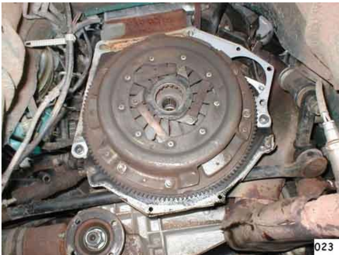
(Fig. 24). Controllare che il volano non sia eccessivamente rigato, se necessario smontarlo e tornirlo; verificare sotto al volano che non ci siano perdite d'olio.
