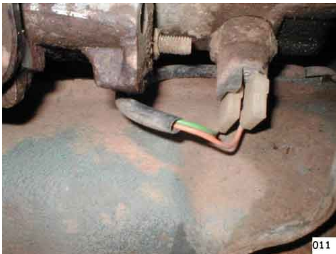
(Fig. 13). Togliere la coppiglia, svitare il dado ed i bulloni che fissano il cilindretto idraulico della frizione al cambio.
