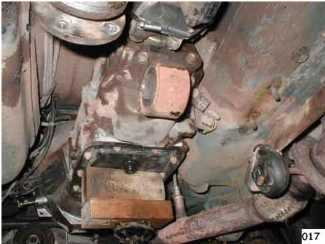
(Fig. 18). Togliere i 3 bulloni che tengono uniti la flangia in uscita del cambio al giunto elastico.
