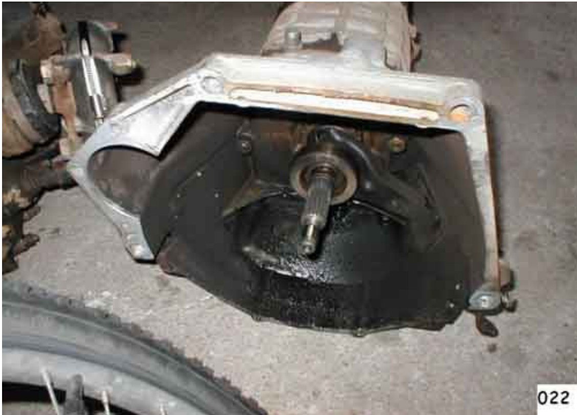
(Fig. 23). Smontare disco e spingidisco.
