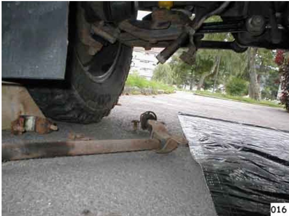
(Fig. 17). Togliere la protezione del catalizzatore, mettere un cric (usando un tacco di legno) sotto il cambio, svitare i 4 dadi della traversa del supporto posteriore del cambio, se dà fastidio toglierla svitando il bullone passante sul silent-block.
