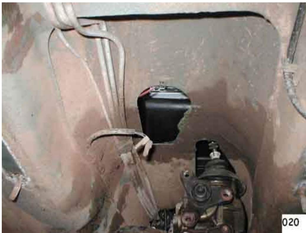
(Fig. 21). Posizionare il cric sotto il cambio, svitare i 4 bulloni che tengono uniti la campana del cambio al motore; togliere i 2 bulloncini in basso che tengono la lamiera di protezione del volano.
