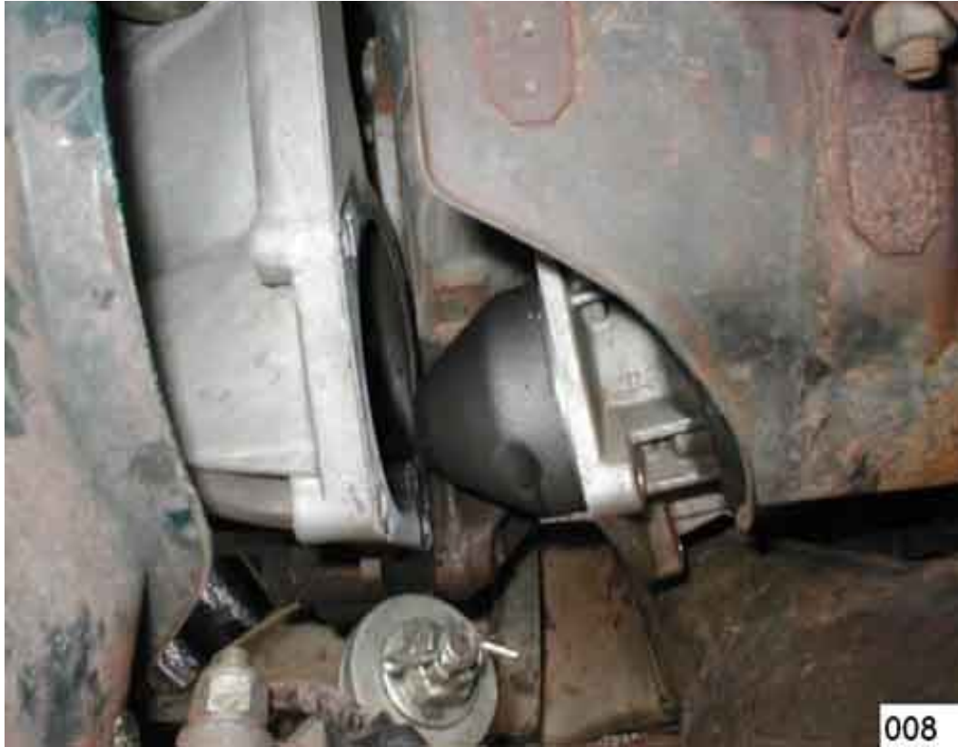
(Fig. 9). Togliere l'albero di trasmissione anteriore, staccare dal riduttore l'albero trasmissione posteriore e spostarlo su un lato.
