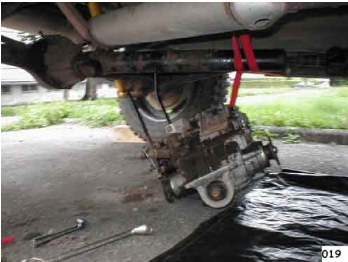
(Fig. 20). Piazzare un cric sotto il riduttore e farlo scendere a terra.
