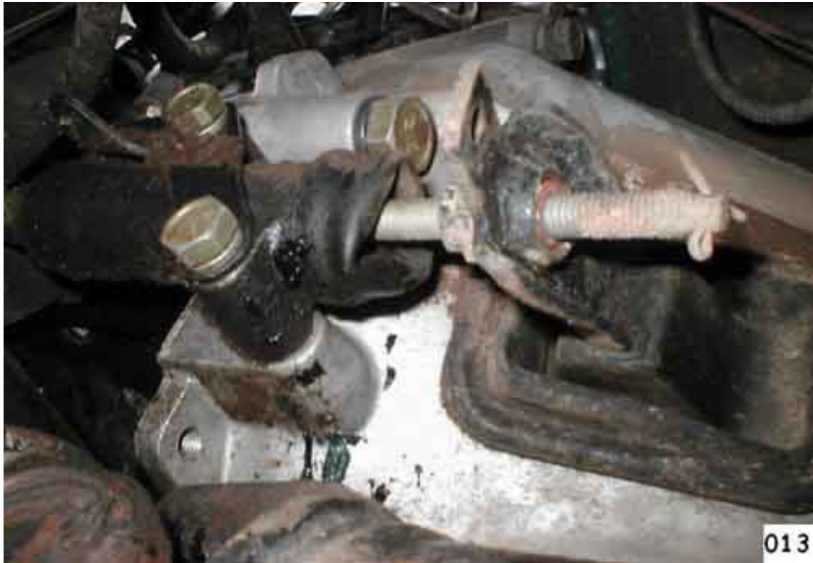
Scollegare il filo di massa. (Fig. 15). Stringere una fascetta attorno al giunto elastico tra cambio e riduttore.
