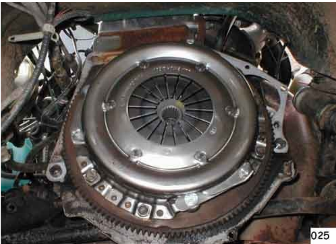
(Fig. 25). Montare la frizione nuova e centrarla usando l'attrezzo costruito.
